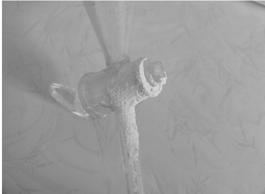
图 2 B24 井凝析气体中析出的单质硫
