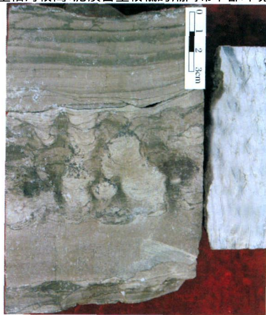
图3 鄂尔多斯盆地榆 9 井叠层石灰岩 (2 331m 段, O 1 m 5 )
